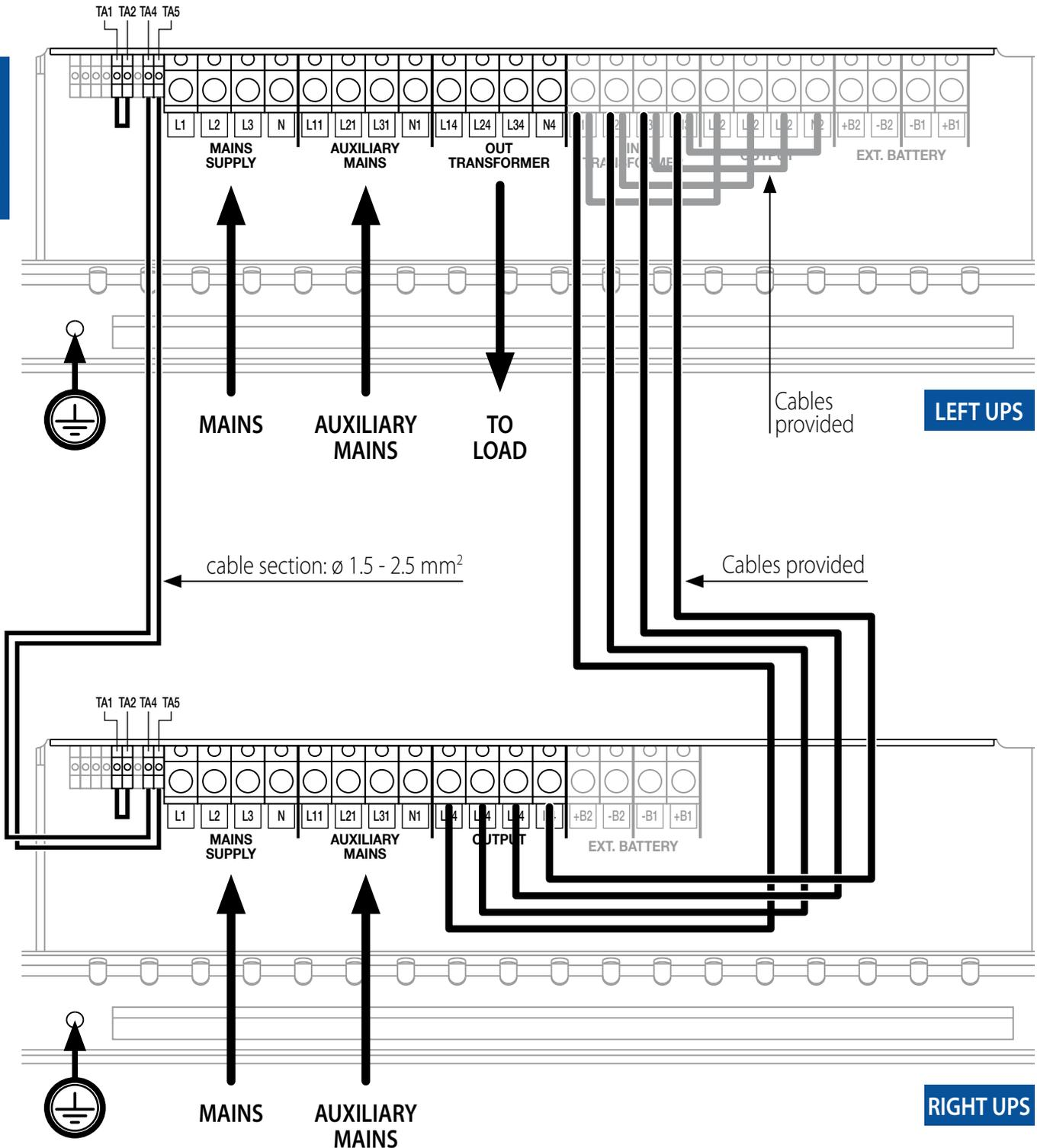
3/1 PARALLEL 1+1 REDUNDANT CONFIGURATION CONNECTIONS.
