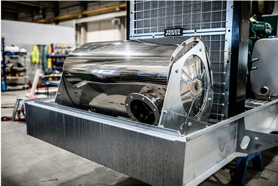
Katalysator med partikelfilter
